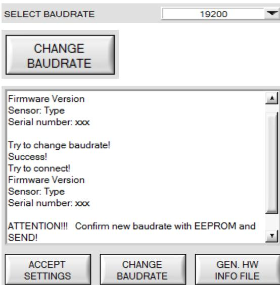
Unter **SELECT BAUDRATE** kann jetzt eine neue Baudrate ausgewählt werden. Durch Drücken von **CHANGE BAUDRATE** wird die neue Baudrate zum Sensor übertragen.
